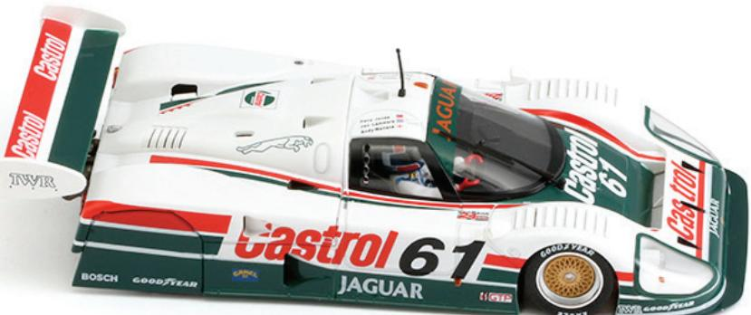
Il telaio era una monoscocca in fibra di carbonio. Il motore un V12 a due valvole per cilindro. Nel 1990, la cilindrata era di 6 litri per la versione IMSA e 7 nella configurazione rispondente al regolamento Gruppo C; questi valori furono aumentati nel 1991, passando a 6.5 litri per quella americana e 7.4 per quella europea. Il peso era rispettivamente di 930 e 1000 kg.
