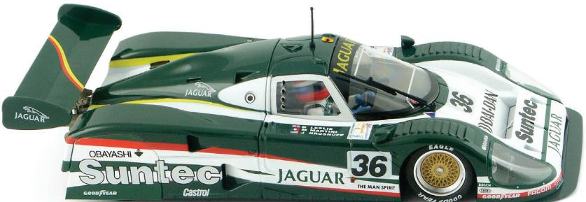
Il telaio era una monoscocca in fibra di carbonio. Il motore un V12 a due valvole per cilindro. Nel 1990, la cilindrata era di 6 litri per la versione IMSA e 7 nella configurazione rispondente al regolamento Gruppo C; questi valori furono aumentati nel 1991, passando a 6.5 litri per quella americana e 7.4 per quella europea. Il peso era rispettivamente di 930 e 1000 kg.
