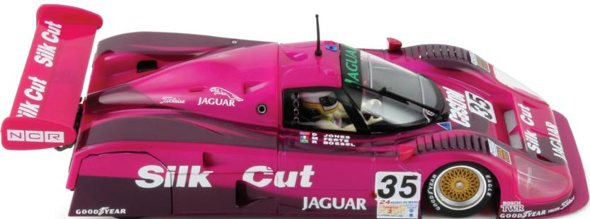
Il telaio era una monoscocca in fibra di carbonio. Il motore un V12 a due valvole per cilindro. Nel 1990, la cilindrata era di 6 litri per la versione IMSA e 7 nella configurazione rispondente al regolamento Gruppo C; questi valori furono aumentati nel 1991, passando a 6.5 litri per quella americana e 7.4 per quella europea. Il peso era rispettivamente di 930 e 1000 kg.
