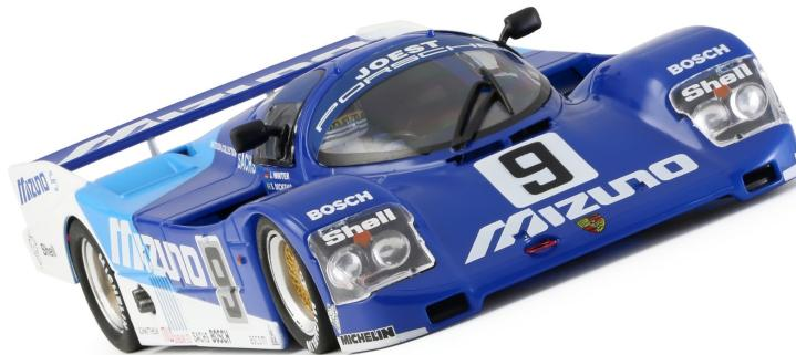
Sulle 3 auto impiegate dal team ufficiale alla 24 Ore del 1988, la cilindrata era stata incrementata a 3 litri. Era stata rinnovata anche la coda, dal profilo allungato per ridurre al massimo la resistenza sul lungo rettilineo di Les Hunaudières. Le 962C ufficiali, in prova, raggiunsero i 391 km/h.
