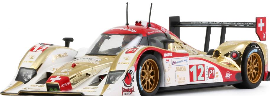
Freni con pinze AP Racing a quattro pistoncini, dischi in carbonio ventilati. Ruote di diametro 18 pollici. Il peso è 900 kg, il minimo previsto dal regolamento.
