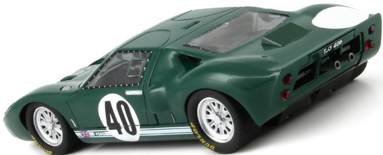
Lo sviluppo della 'Mk I' fu svolto principalmente dalla Ford Advanced Vehicle in Inghilterra, a cui si aggiunse Carroll Shelby nel 1965. Fu un'auto da competizione, ma anche stradale, da cui il nome di 'GT40', dove '40' sta per l'altezza dell'auto misurata in pollici. Il telaio era una semi-monoscocca in acciaio, con carrozzeria in fibra di vetro.
