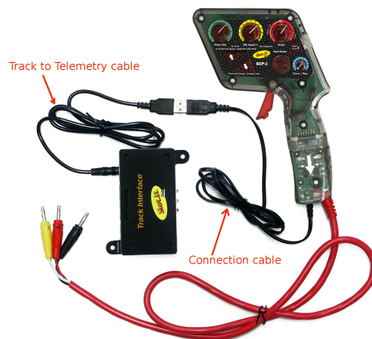
Figura 7: collegamento della Track Interface alla Telemetry Box
