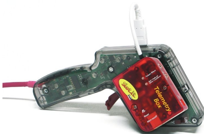
Figura 11: telemetry box montata sul pulsante SCP
