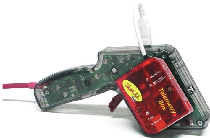
Figura 11: telemetry box montada en el mando SCP
