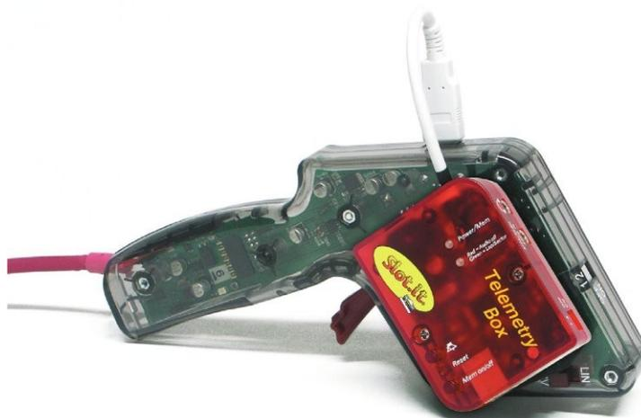
Figura 11: Telemetry Box montata sul pulsante SCP.
