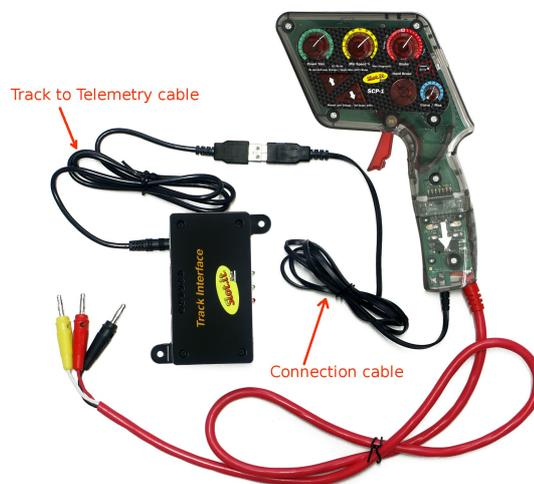
Figura 29: collegamento della Track Interface alla Telemetry Box.
