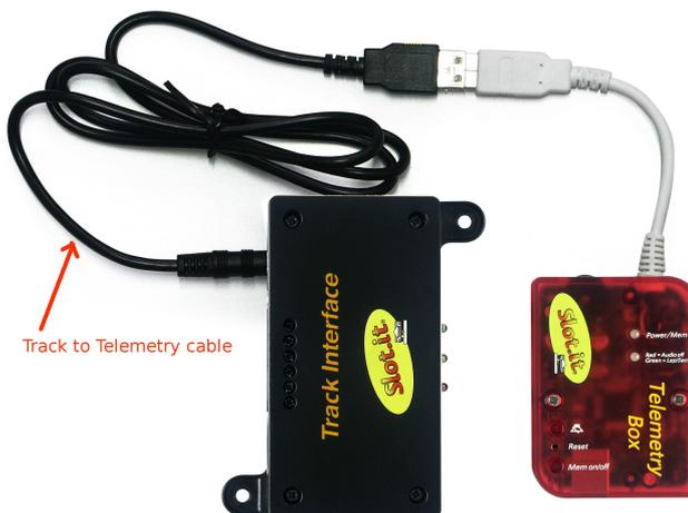
Figura 30: collegamento della *Track Interface* alla *Telemetry Box*.
