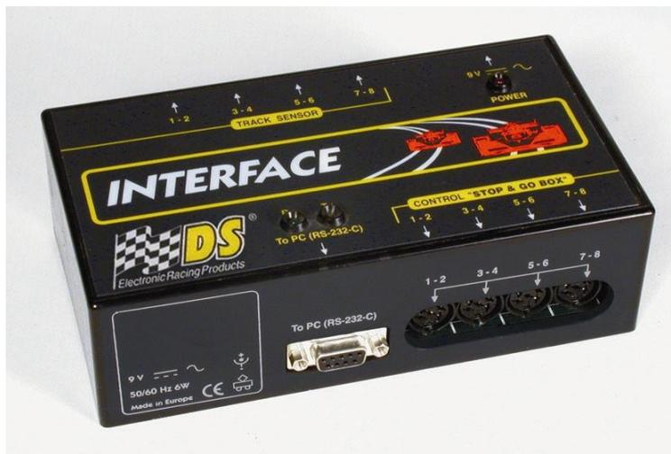
La **installazione** del DS-INTERFACE si ottiene semplicemente connettendo i diversi cavi dei **sensori** della pista e dello **Stop & Go** all'interfaccia DS-INTERFACE.
