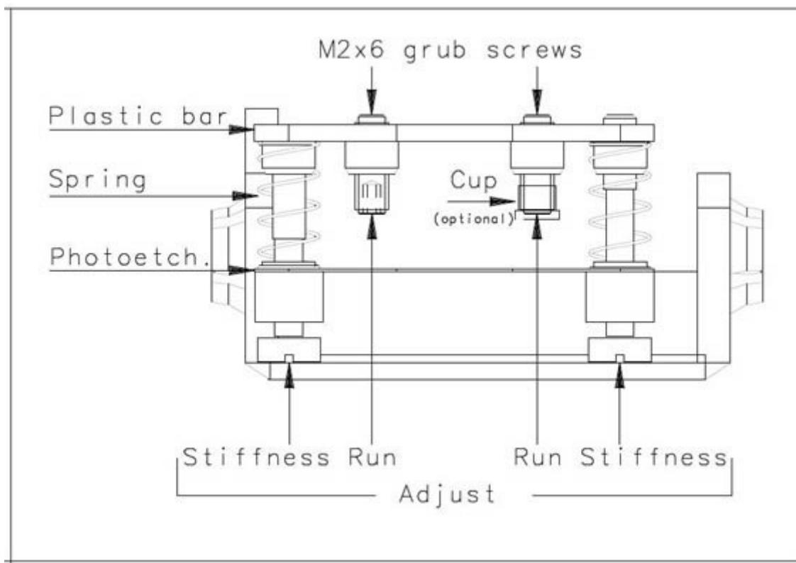
Una volta montato all'interno della macchina, sia la rigidità delle molle, sia la lunghezza della corsa delle sospensioni possono essere regolate senza dover rimuovere il telaio.
