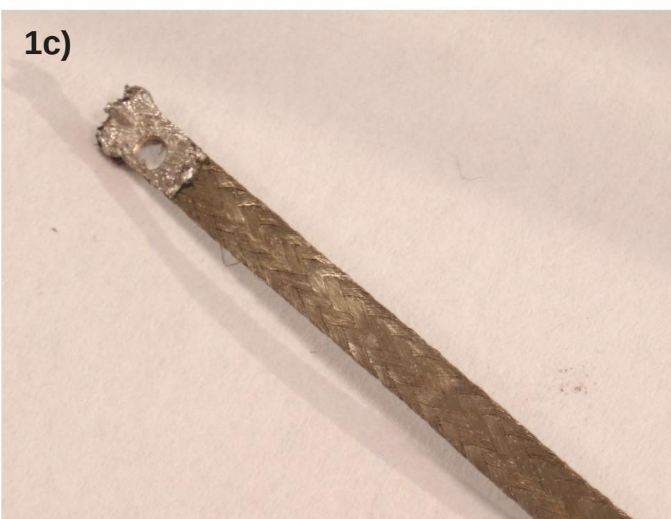
Realizzare una stagnatura sull'estremità della treccia. La stagnatura non dovrà essere troppo spessa, per potersi infilare all'interno del pick-up.
