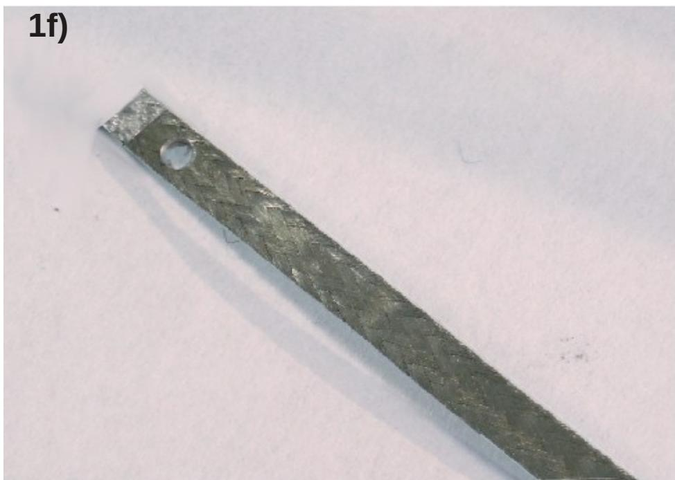
Una semplice alternativa consiste nell'inserire una treccia nel pickup, e, utilizzando una punta di diametro opportuno (1-1.5mm), forare la treccia che, mantenuta all'interno del pickup, manterrà la forma corretta senza deformarsi durante la perforazione.
