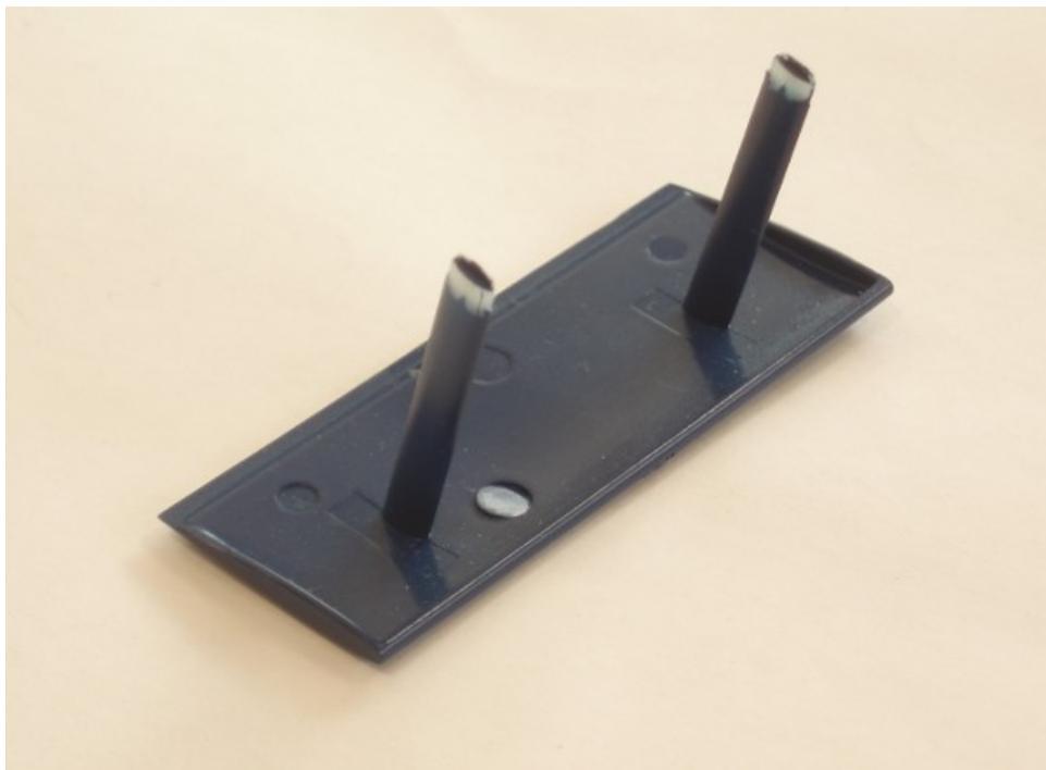
Una volta tolta la carrozzeria dall'auto, ho eliminato la lunghezza in eccesso dei pin che servono a fissare il pilota all'abitacolo.
